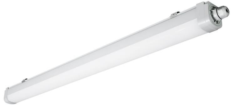
START Waterproof Slim ist eine Leuchte mit integriertem LED-Polycarbonat-Gehäuse und leicht zugänglichen elektrischen Anschlüssen durch Endkappen mit Bajonettverschluss und werkzeugfreiem elektrischem Anschluss durch Push-in-Klemme. Flexible Installation, da die Montagebügel frei an der Leuchte positioniert werden können. 4.650/2.300 lm (wählbar über DIP-Schalter), 34,5/17 W, 135/135 lm/W und 100.000 Stunden Lebensdauer L70B50. SDCM < 5. IP66. IK08. Klasse II. 1.240 x 70 x 73 mm.
